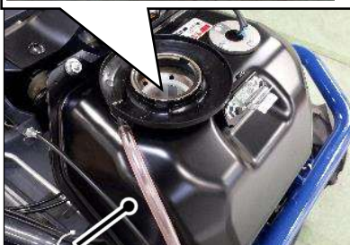
燃料ドレンホース
